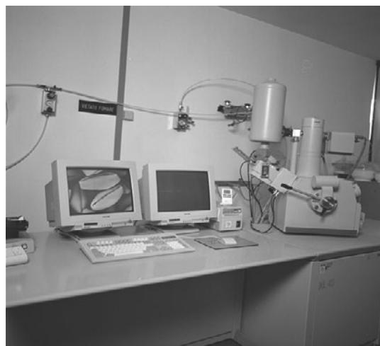
Fig. 4. SEM at Philips XL 40 ENEA - Dept. FIM
