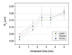
Fig. 5. Evolution of roughness with immersion time in aqua regia
